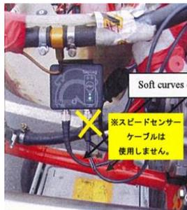
M6×2の穴をシートの背中部分にあけて、UniLogホルダーを強固に固定してください。
